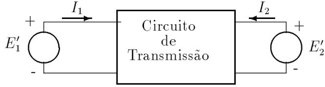
**Figura 7.2:** Esquema de um gerador fornecendo potência através de uma linha de transmissão a uma barra terminal 2
