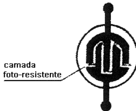
Estrutura de uma foto-resistor aumentada em algumas vezes.
