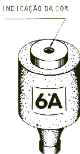
Figura 30 - Indicação da cor no fusível Diazed
