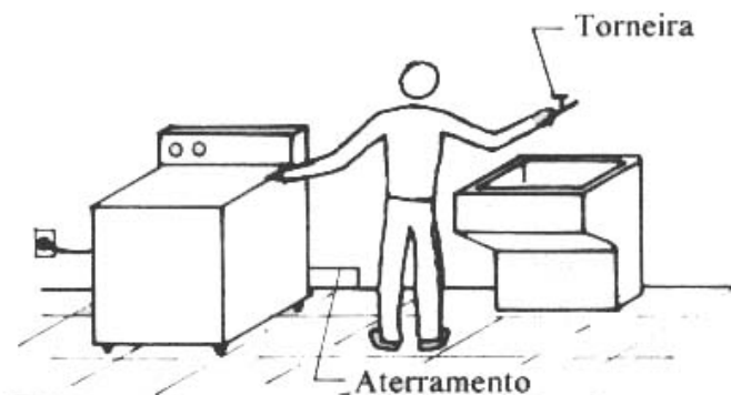
Figura 21 - Aterramento da máquina de lavar
