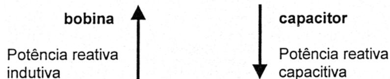
Devido a isto utiliza-se o capacitor para melhorar o fator de potência (cos. Baixo) das instalações.
